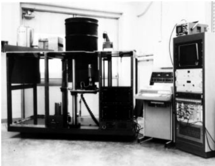
Рис. 6.18. Система SGS для сканирования бочек емкостью 55 галлонов
