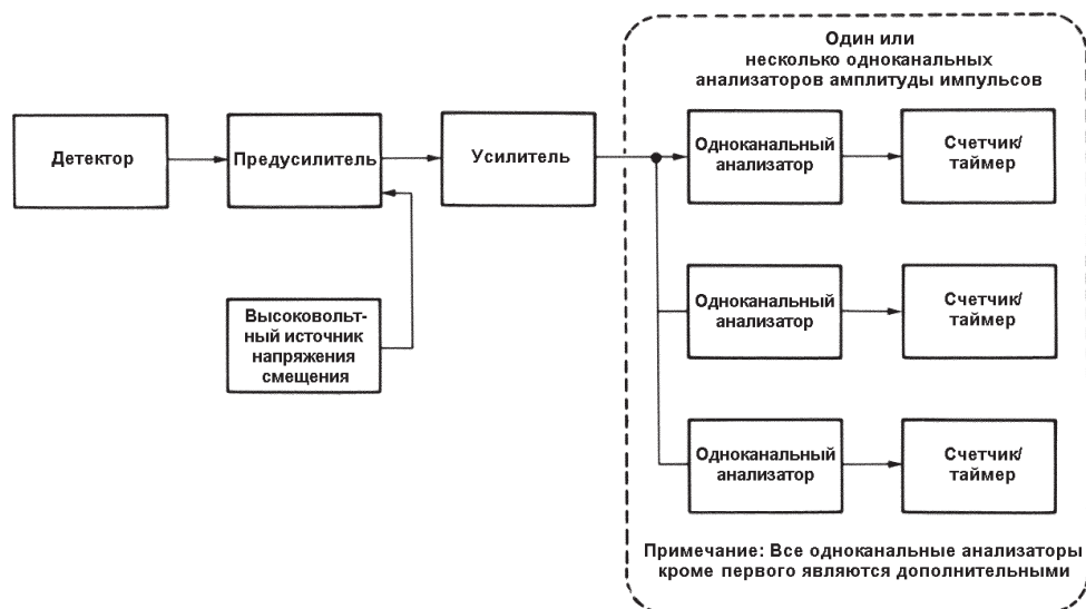
Рис. 4.1. Блок-схема гамма-спектрометрической системы, основанной на одноканальных анализаторах, для простых случаев НРА
