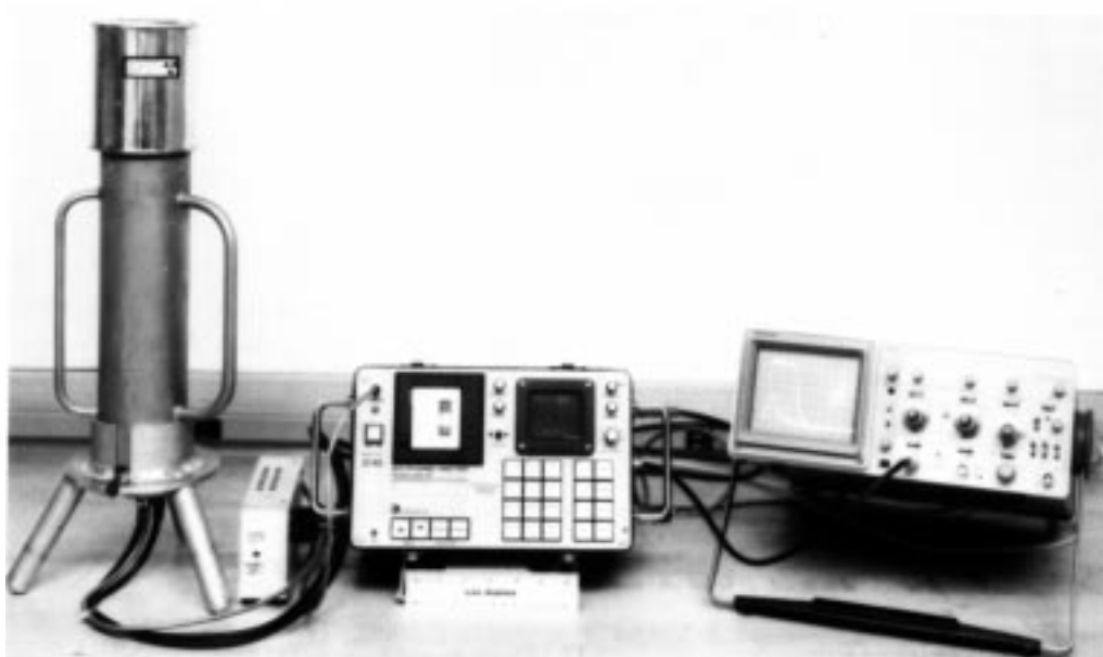
Рис. 7.6. Оборудование для измерения обогащения урана по гамма-излучению, включающее портативный микропроцессорный многоканальный анализатор и детектор гамма-излучения NaI(Tl). Аппаратура может питаться от батарей и пригодна для применения в полевых условиях
