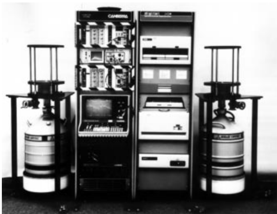
Рис. 8.17. Многодетекторная система для измерения изотопов плутония в Лос-Аламосе
