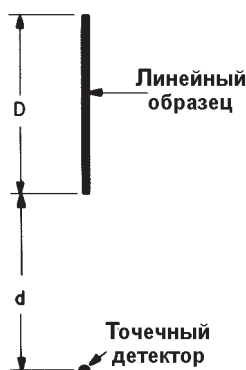
Рис. 6.6. Одномерная модель для расчета коэффициента CF(AT)
