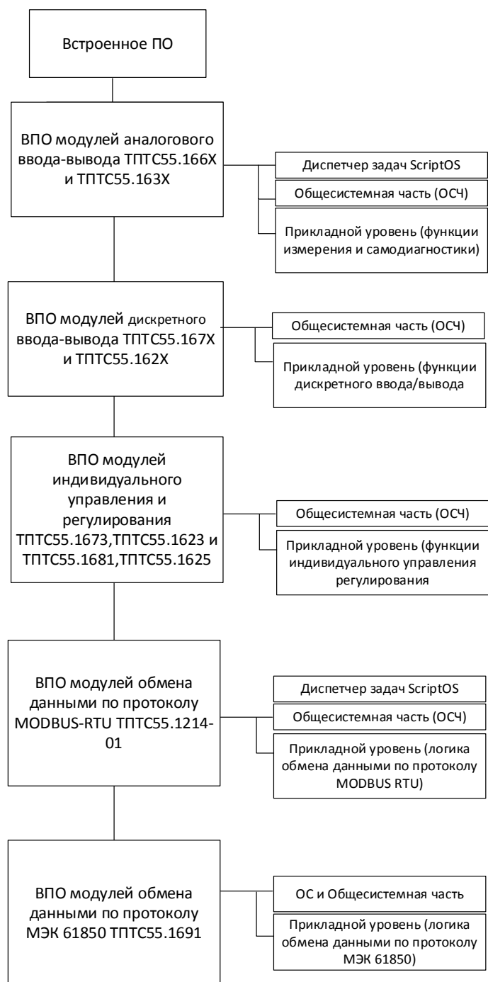
Рисунок 4. Структура ВПО модулей связи с процессом ТПТС-НТ
